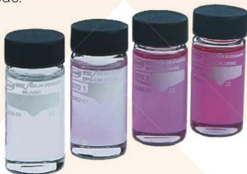
➤ *Esempio di diversa intensità di colore sviluppata dalla reazione DPD*
